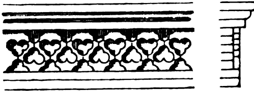
Fig. 5. Glasiertes Maßwerkfries des Hauptgesimses.
