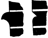
Fig. 10. Kirchbaggendorf. Kirche. Gesimse.
