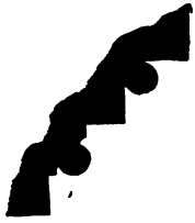
Fig. 18. Gützkow. S. Nicolaikirche. Langhaus. Thürprofil.
