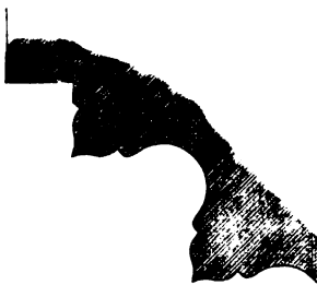
Fig. 18. Reinberg. Kirche. Profil einer Thürlaibung im Schiff.
